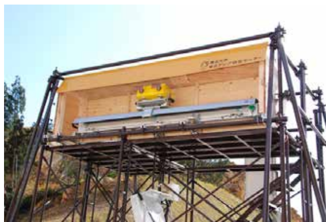
図 2.11 荒砥沢に設置した GB-SAR 装置
