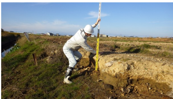
侵食深を計測する様子
