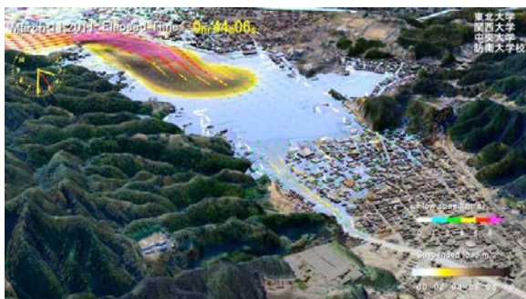
図 津波統合モデルによって再現された、東日本大震災の宮城県気仙沼市の津波氾濫・土砂移動・船舶漂流の様子（巻き上げられた土砂によって濁った津波が市街地に襲来し、船舶（図中の白い物体）が漂流する）
