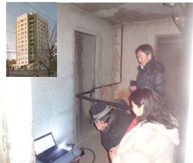
PCパネル工法による12階建建物と振動測定の様子
