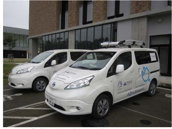
非常用電源として使用した EV
