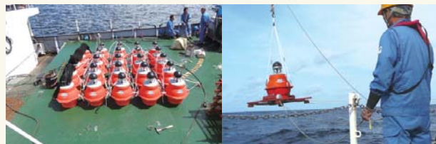
【図1】深海精密トランスポンダの投入設置作業
