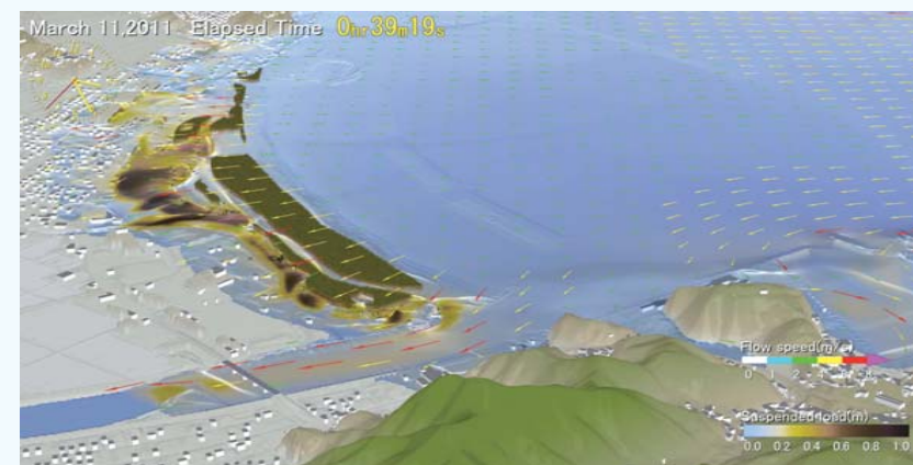
山下助教が取り組んでいた津波土砂移動シミュレーション研究
