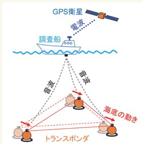
【図2】船上からトランスポンダへ音波を送る（船の位置はGPSで計測）
