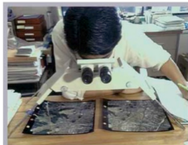
空中写真の実体視の作業
