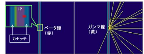
カセット内に入り込んだ放射性物質のβ線はIP(イメージングプレート)で吸収され黒点の原因になる。だが右図のようにガンマ線はIPにはほとんど吸収されない。
