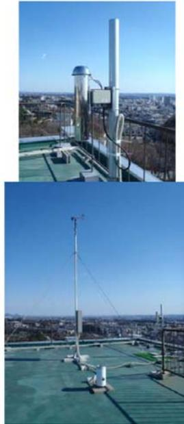
↑ 台風Megi (2010)の数値予報モデル(JMA-NHM)によるシミュレーション 左上:衛星による雨量, 左下:シミュレーションによる雨量, 右上:台風の経路, 右下:台風の強度(中心気圧) → 北青葉山キャンパスに設置した自動気象観測装置. 上は今年度増強した温湿度計
