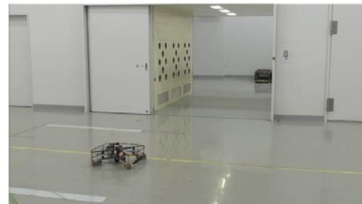
・磁力で天井に吸着し、プロペラを使わず糸を手繰って上下移動
