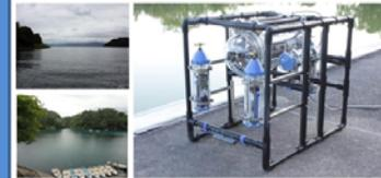
福島県には多くの湖沼が存在し、その放射能汚染調査は十分ではない。本研究の目的は、湖の湖底の放射能濃度マップ作製を行うことである。このような調査には、運用が容易で100m程度の深度（猪苗代湖）が取れ、サンプリングの繰返し位置精度の高い小型水中ロボットを用いるのが有用である。
