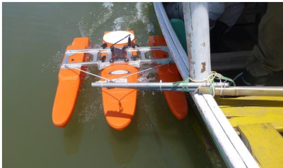
河床形状測定の様子（リバーボート：ポテ丸 Jr.）
