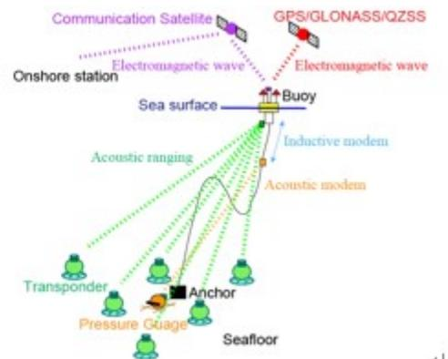
図3 地震・津波観測と警報システム
