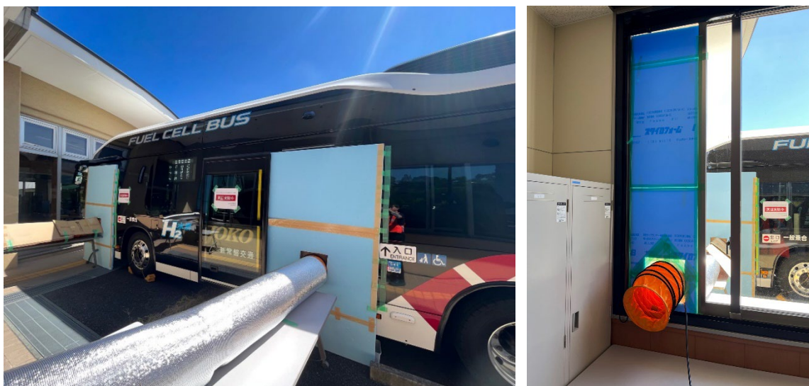
FCバスからダクトを使用して冷気を循環させている様子
