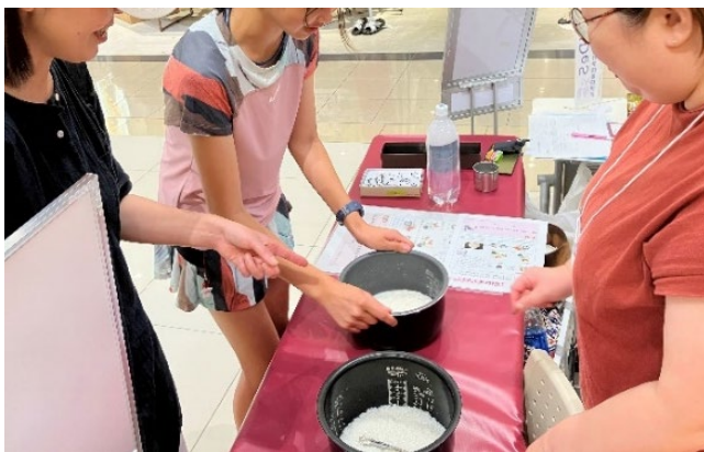
米の入ったお釜をゆすって金属製スプーンを沈める、液状化の実験
