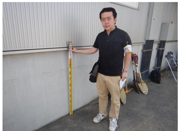
痕跡水位より浸水深を計測する様子
