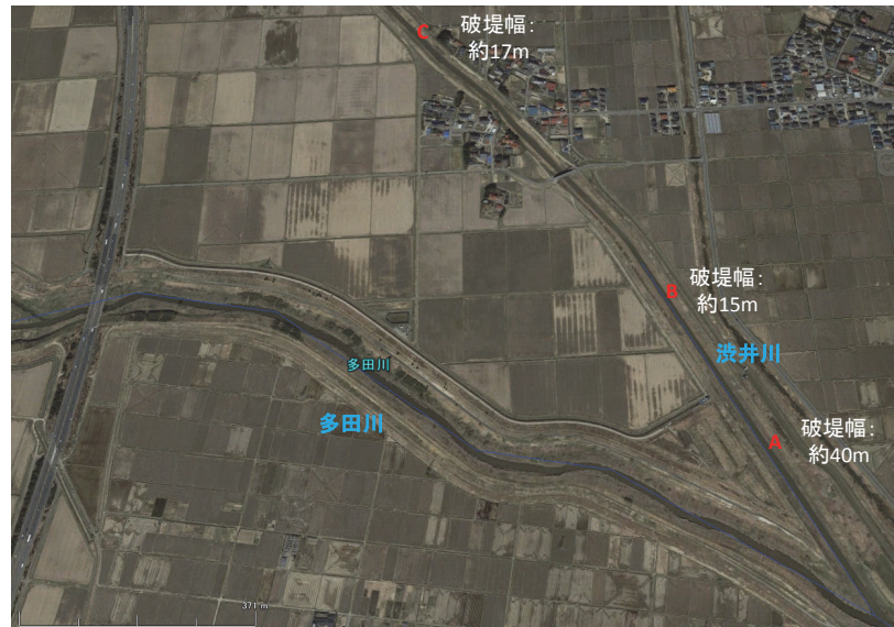
図-4 破堤発生位置および破堤幅
