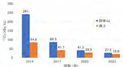
図2 高濃度放射性セシウム汚染地(御幸山)と中濃度放射性セシウム汚染地(斜面)で採取したサクラ粗皮における 137 Cs濃度の経過標記の幅(誤差)は合成標準不確かさ(1σ)
