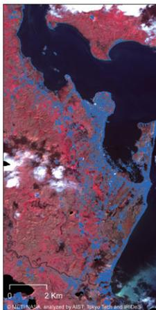
(図1)衛星画像解析から明らかになったタクロバン市周辺の高潮浸水範囲。画像提供:越村俊一、エリック・マス、ブルーノ・アドリアノ、郷右近英臣(以上、災害科学国際研究所)、松岡昌志、リュウ・ウェン(以上、東京工業大学)
