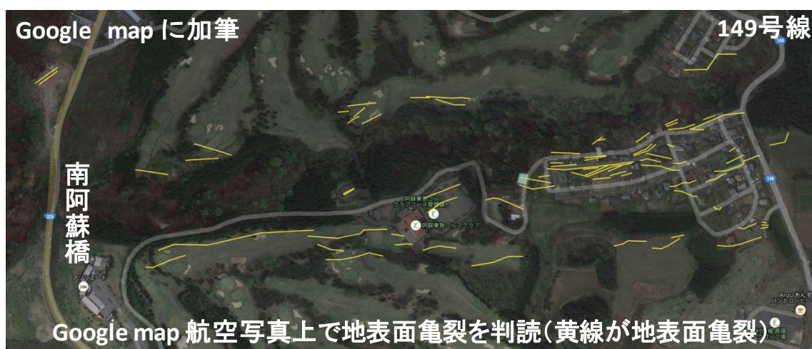
図 3 1 宅地造成地およびその周辺の地表面亀裂 (Google map に加筆)
