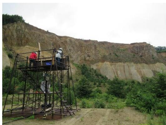
図1 GB-SAR を設置した栗原市・荒砥沢地区の大規模崖崩れ地点
