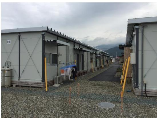
写真 8 阪神大震災以来大量供給されてきたプレハブ型応急仮設住宅
