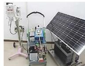
災害時X線撮影用X線発生システム試作機
