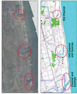
山元海岸後背地にある多数の旧水路・湿地 戻り流れが集中して侵食、津波溝形成、破壊に至る
