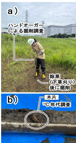
Fig.2 掘削調査 a) 調査の様子 b) コアサンプル (木片) c) TYAの柱状図 d) 柏尾川沖積低地地質縦断面図 ※ 断面モデルの精度を上げるために範囲を特定し、高密度に掘削調査を実施する必要性が判明した。 ※ 14 C年代測定によりUBH築造当時(鎌倉時代)の地盤面は、現在より約1.0~1.6m低い位置と想定された。
