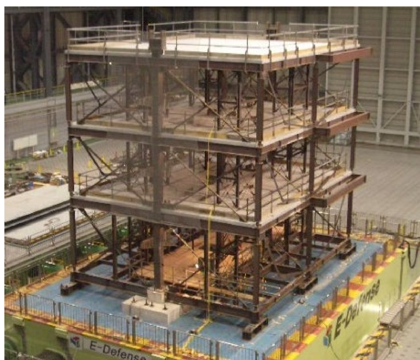
実大三層鉄骨造の振動台実験 @E-Defense
