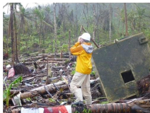
高波の浸水高を計測する Bricker 准教授
