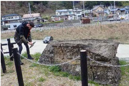
Lidar を用いた津波石の計測
