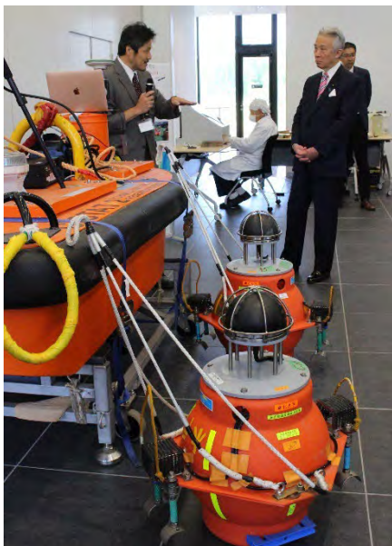
海底地殻変動観測について解説する木戸元之教授（左）。写真手前がトランスポンダ
