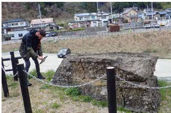
Lidar を用いた津波石の計測
