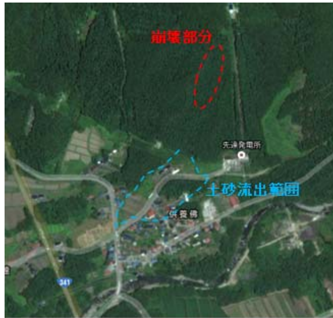
図-8 崩壊部分と土砂流出範囲 (Google map に加筆)
